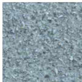
F: Fin Gradering: 1-3 mm
